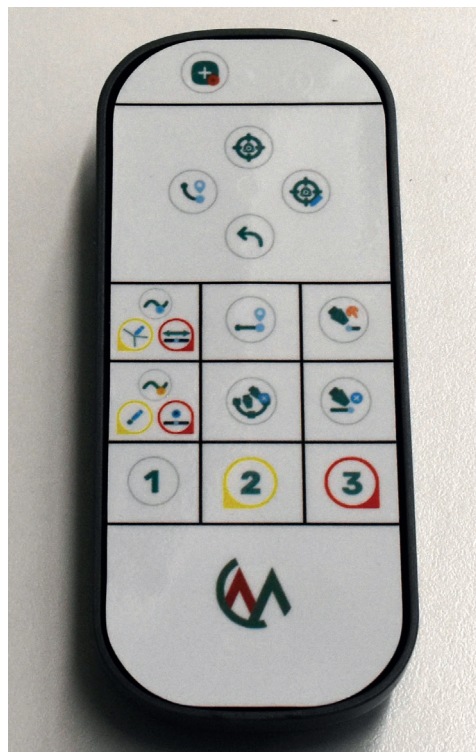
Figura 3 - Telecomando per la registrazione dei punti e dei comandi.
