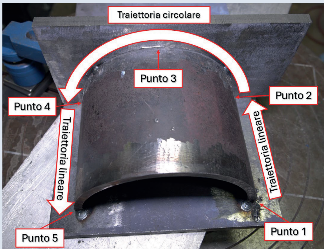
Figura 8 - Giunto 2 (5 punti che vanno a comporre due tratti lineari connessi da una traiettoria circolare).
