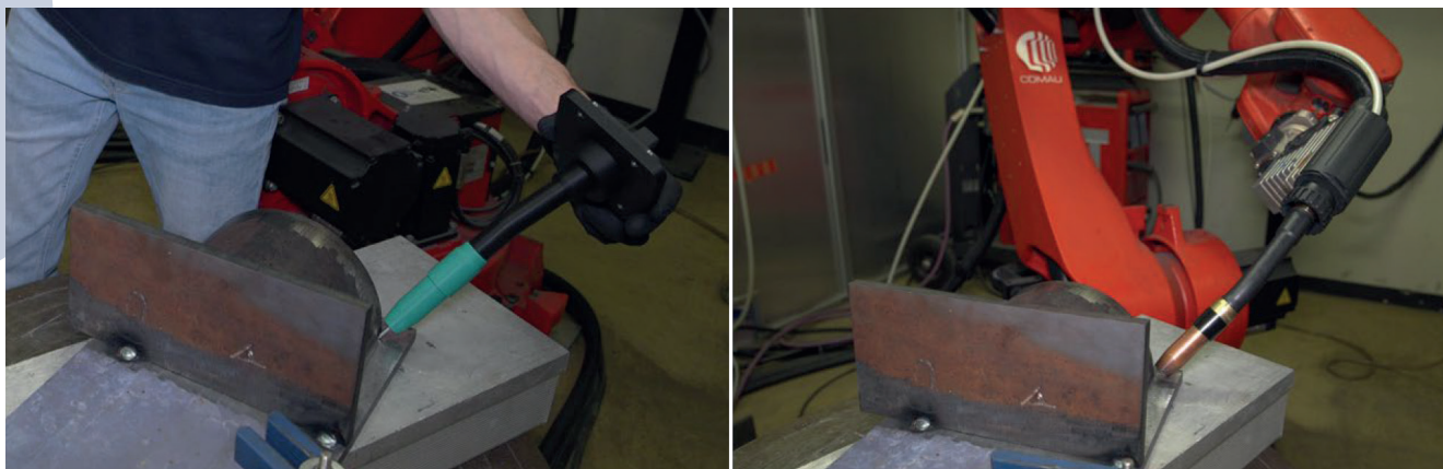
Figura 16 - Giunto 2, punto 5: confronto tra posizione tracker (a sinistra) e tool/robot (a destra).
