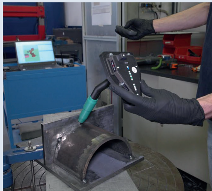
Figura 9 - Registrazione dei punti con il sistema tracker/telecomando (a sinistra); ambiente di lavoro virtuale in tempo reale (a destra).
