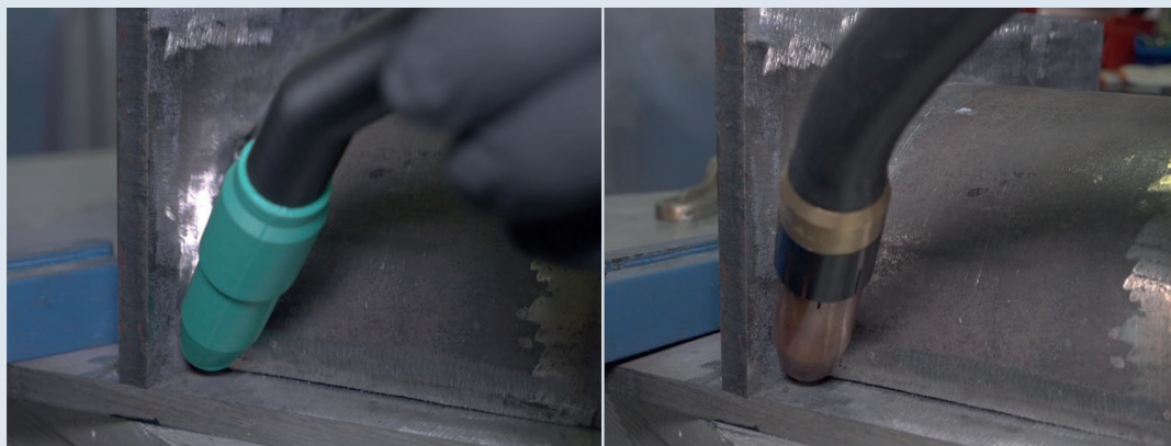
Figura 15 - Giunto 2, punto 4: confronto tra posizione tracker (a sinistra) e tool/robot (a destra).
