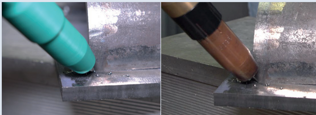
Figura 12 - Giunto 2, punto 1: confronto tra posizione tracker (a sinistra) e tool/robot (a destra).
